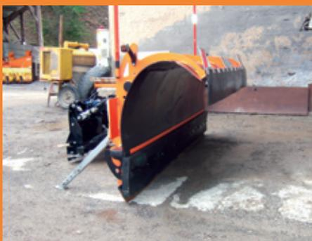
La lame biaise bi-raclage est une lame polyvalente : la lame d'usure acier permet le traitement des neiges gelées, la lame d'usure caoutchouc assure le raclage efficace des neiges fondantes.
